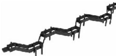
Leichter wellenförmiger PVC-freier Abstandhalter mit gutem Betondurchfluss für den Einsatz im Fertigteilwerk in einer Länge von 118 cm. Kippsicher durch eine Breite von 45 mm. Weniger und kleine Auflagepunkte an der Schalung ergeben weniger sichtbare Abdrücke am Betonfertigteile. Bei Bedarf endlos verlängerbar durch Steckverbindung. Die Form des Abstandhalters gewährleistet eine verzugfreie und rationelle Verpackung.
